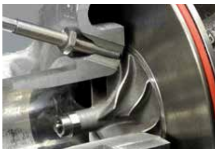
钛合金或铝质叶片的大安装距离测量
